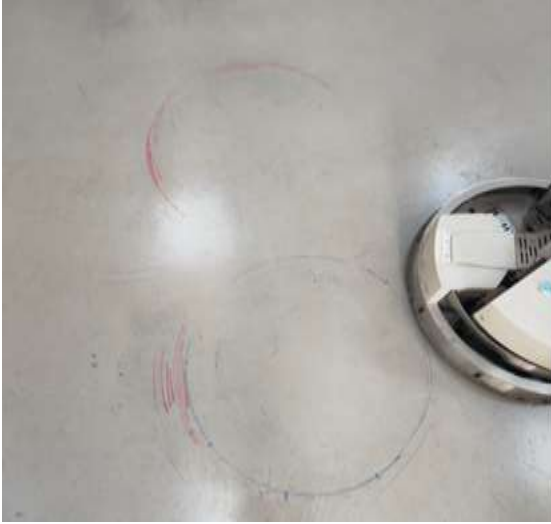
Şekil 12 Robotino 500mm X eksen hareketi kaçıklık deneyi
