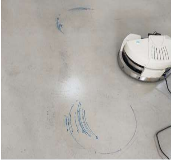
Şekil 14 Robotino 1000mm X eksen hareketi kaçıklık deneyi
