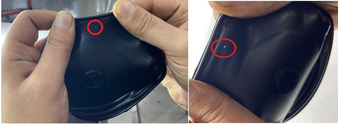
Şekil 1. Deforme olmuş membranlar
