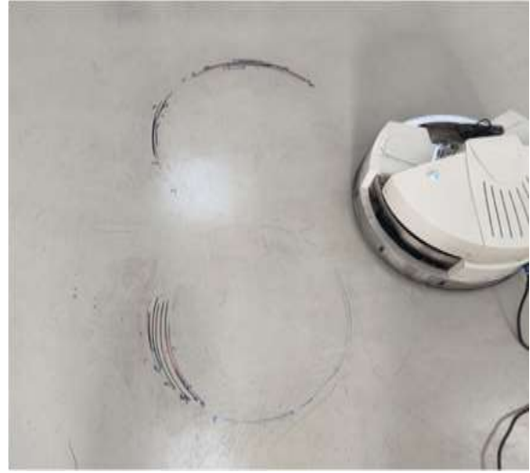
Şekil 12 Robotino 500mm X eksen hareketi kaçıklık deneyi
