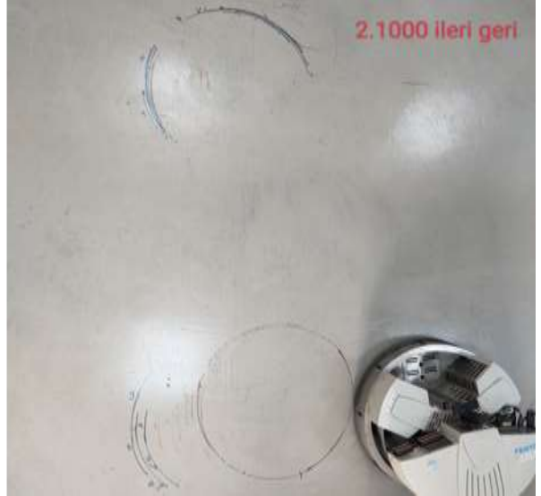
Şekil 14 Robotino 1000mm X eksen hareketi kaçıklık deneyi
