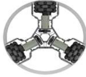
Şekil 10 Robotino 3 mobil otonom robotun OmniWheel tekerlek yapısı
