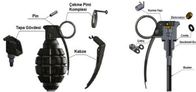
Şekil 1. Mevcut el bomba tapası ve bileşenleri
