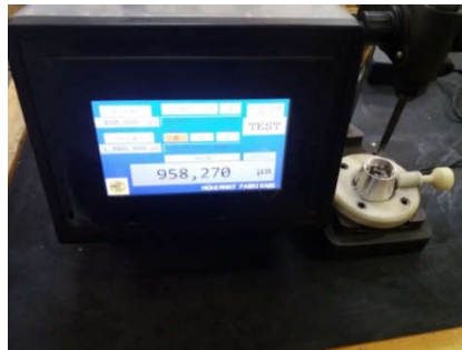
Şekil 4. Kurulma süresi test cihazı
