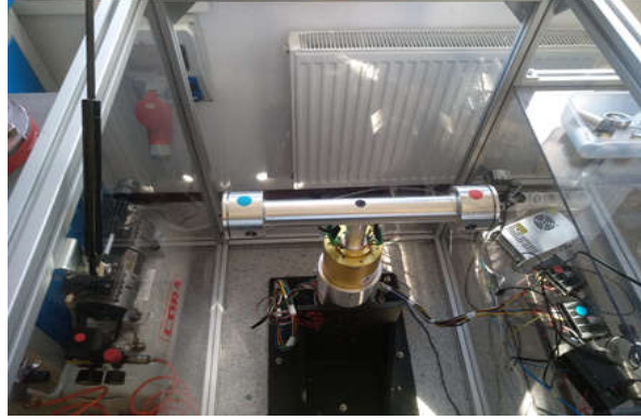
Şekil 5. G kuvveti testlerinin yapıldığı G test cihazı
