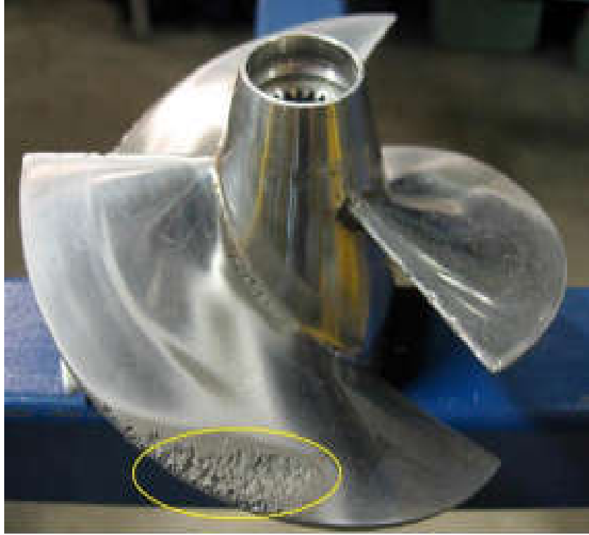
Şekil 2. Gemi pervanesinin yüzeyinde oluşan kavitasyon erozyonu (Sampson 2008)
